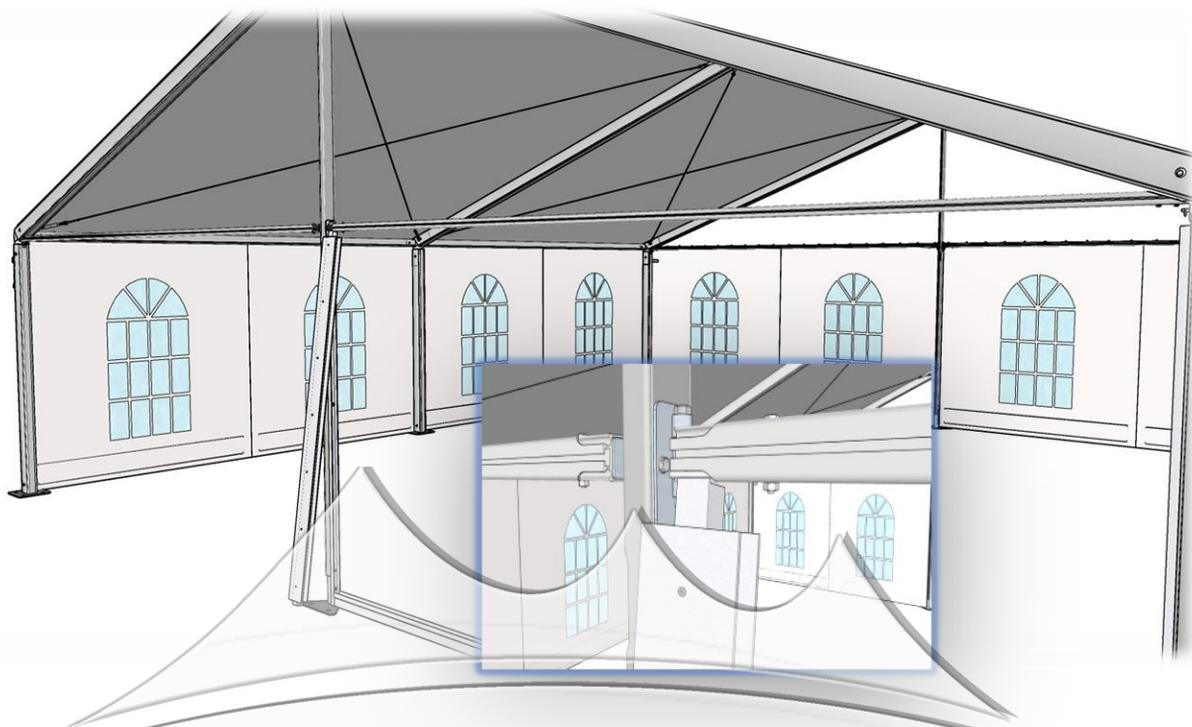
4. Установить хвостовик вертикальной направляющей в нижнюю направляющую балку
