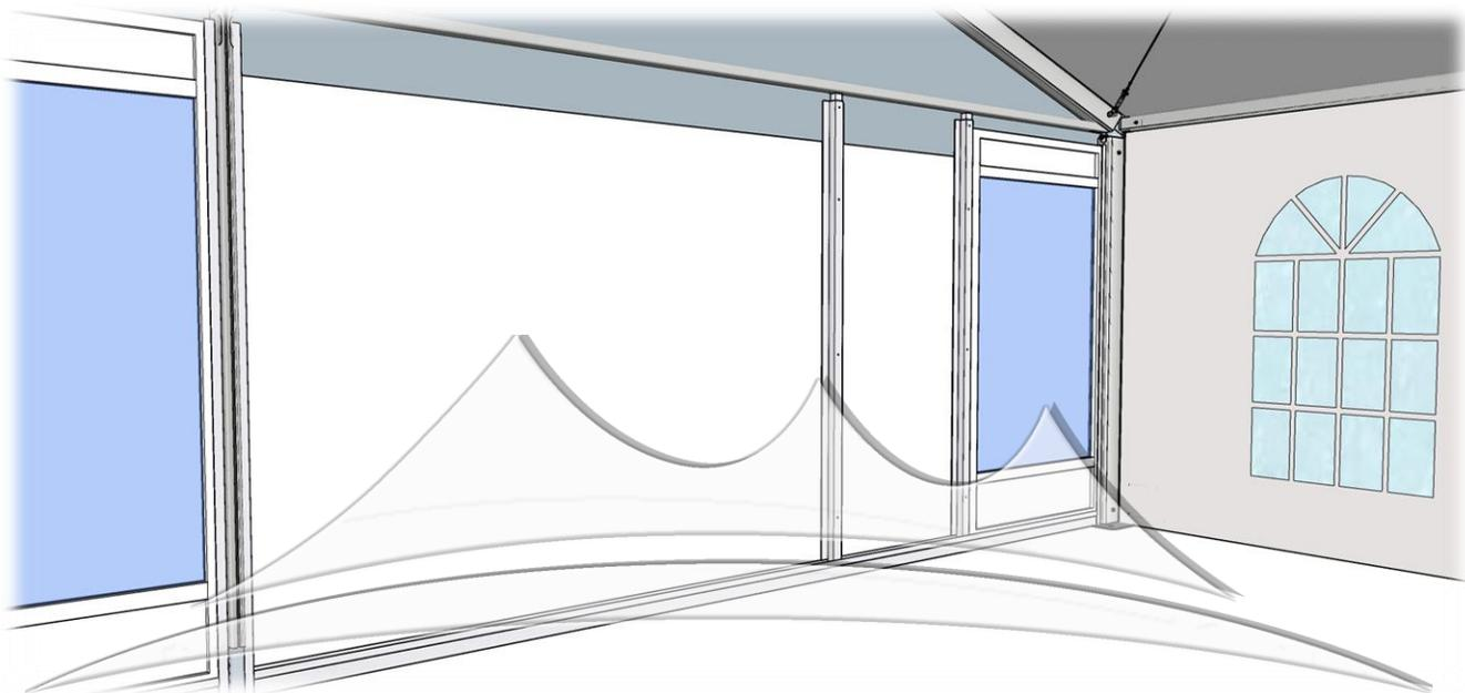
2. Аналогично стеновой панели, установить дверной блок к противоположной опоре шатра
