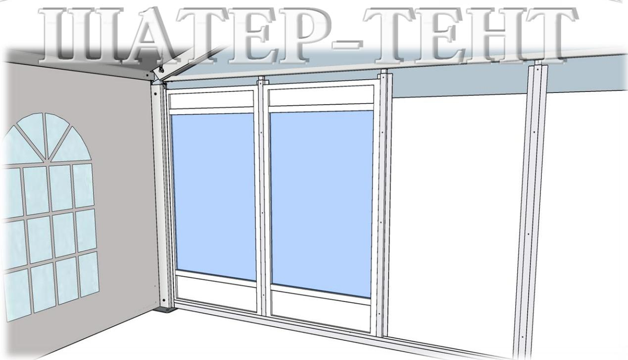
10. После установки второй панели необходимо закрепить прижимной планкой первую вертикальную направляющую
