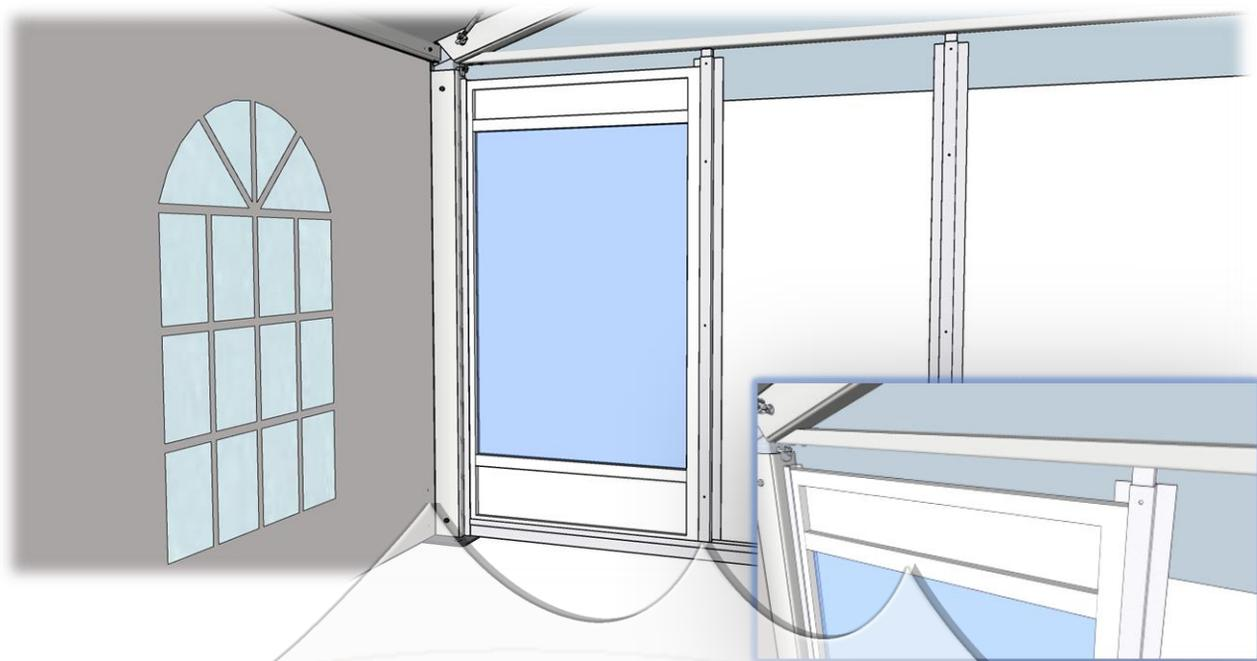
9. Установить вторую панель и задвинуть к ней вторую направляющую
