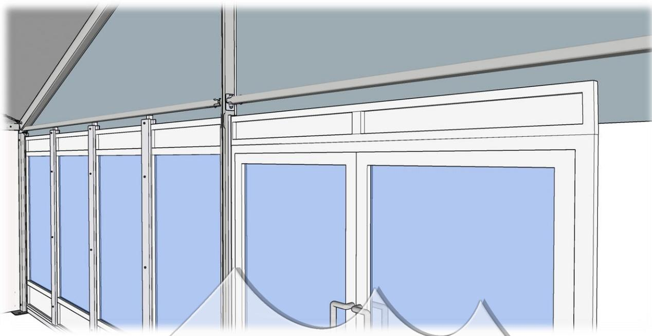
4. После установки доборного элемента, придвинуть вплотную к двери вертикальную планку
