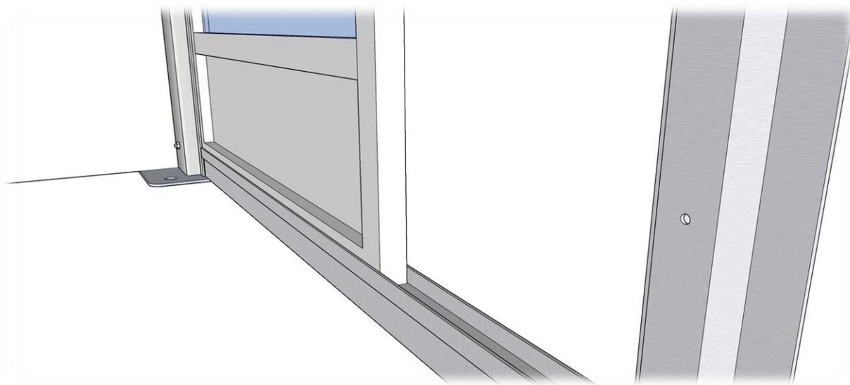
8. Придвинуть вертикальную направляющую вплотную к панели
