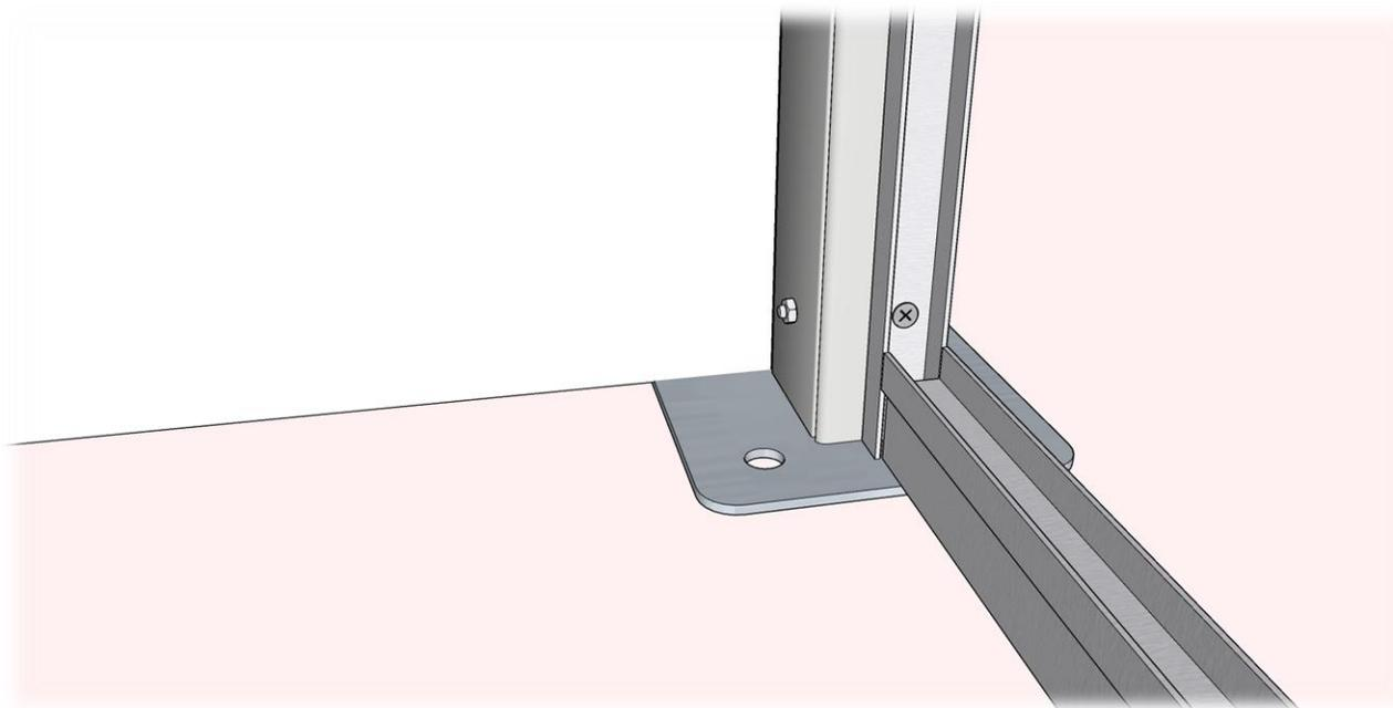
3. Вдеть в профиль, через пазы для заправки кедера, вертикальную стыковочную направляющую и провести ее вдоль балки
